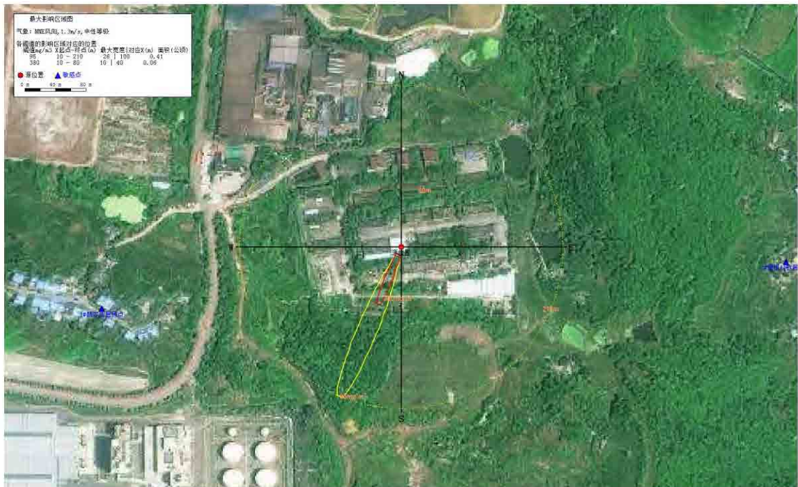
图 7.8-6 次生 CO 泄漏最大影响范围图 (1.5m/s)
