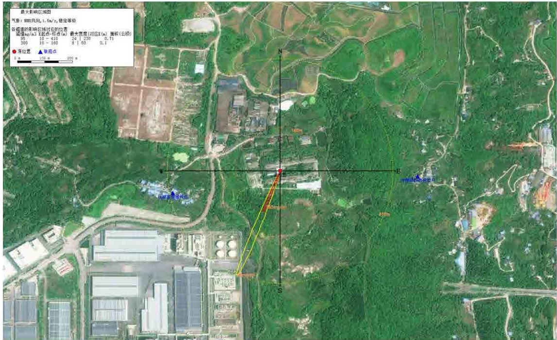
图 7.8-6 次生 CO 泄漏最大影响范围图 (1.5m/s)
