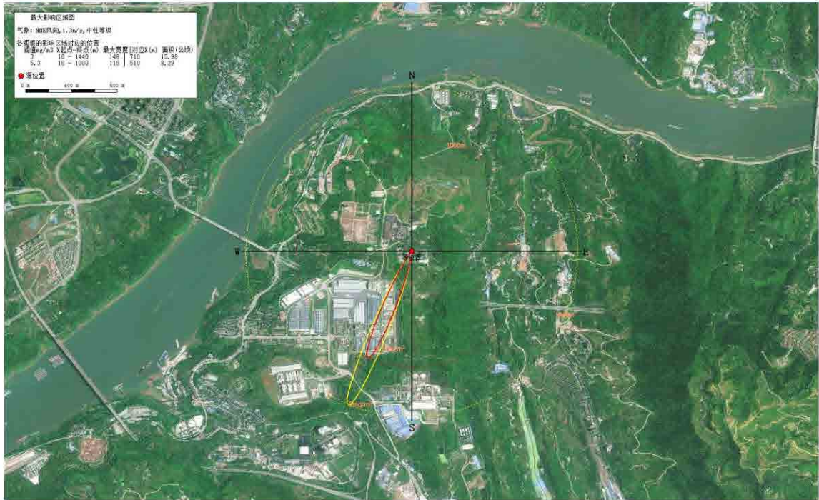
图 7.8-2 三氯氧磷泄漏最大影响范围图 (1.3m/s)
